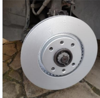
Той самий диск А.В.С. з GEOMET після 18 місяців експлуатації
