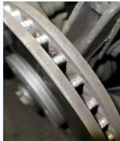
Той самий диск А.В.С. з GEOMET після 18 місяців експлуатації
