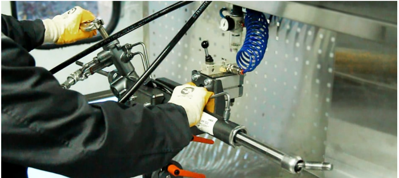
Фото: Діагностика кермової рейки в Master Service
