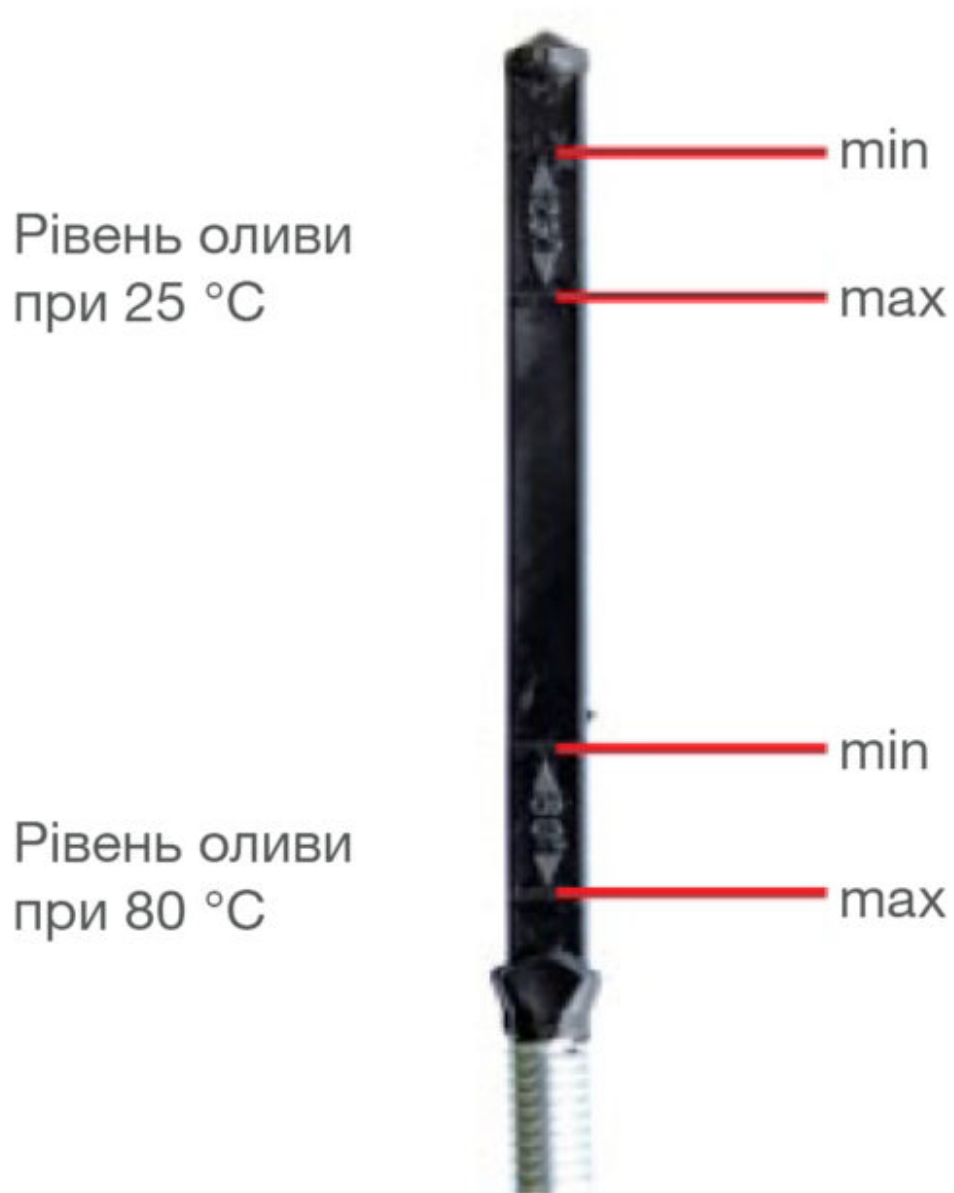
Мал. 2: Розділені діапазони вимірювання масляного щупа
