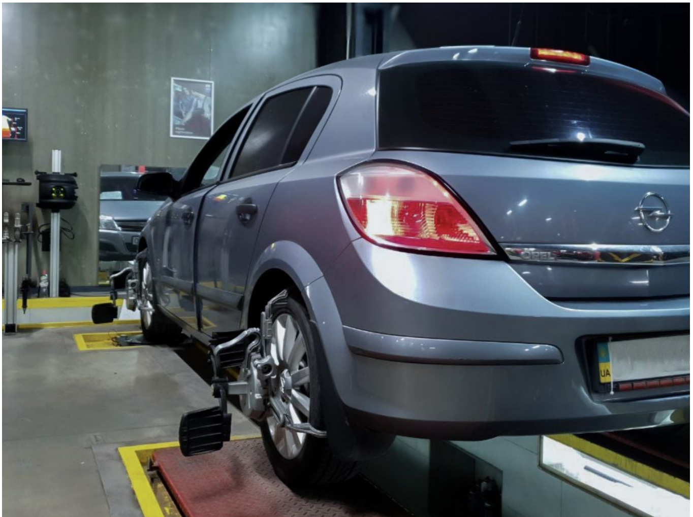
Фото: Встановлення правильних кутів установки колес на 3D-стенді
