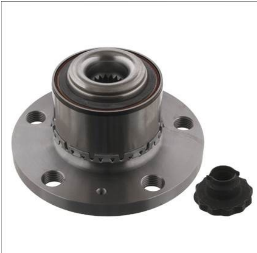
Мал. 3 Комплект Колісного підшипника з маточиною колеса, імпульсним кільцем датчика ABS і осьовою гайкою, febi 32558
