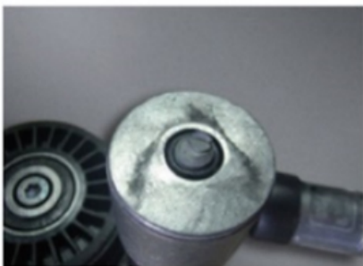
Ламається кріпильний гвинт натяжного пристрою для ремня
