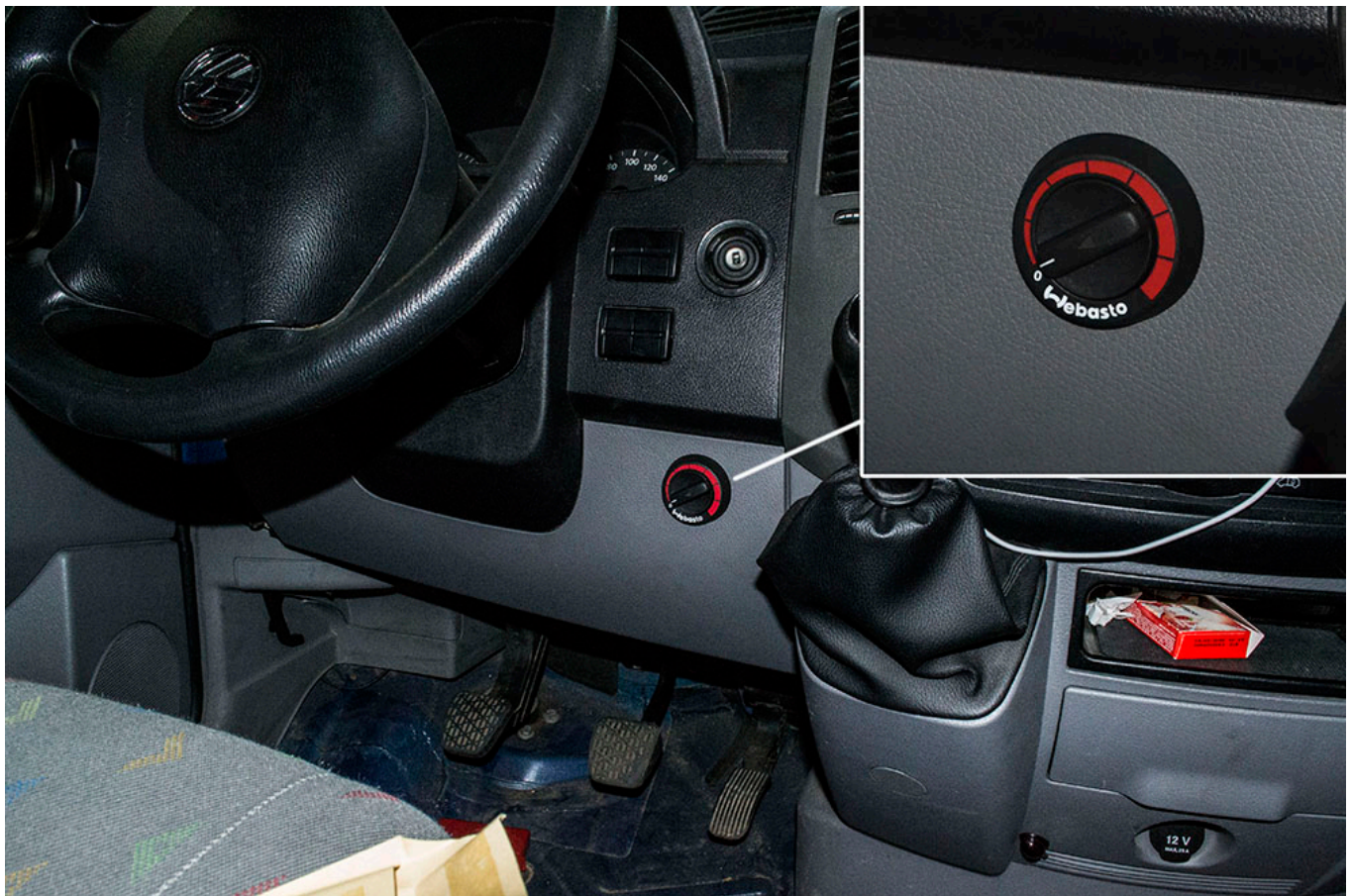
Фото: Управління автономним обігрівачем розташовуємо праворуч під кермом
