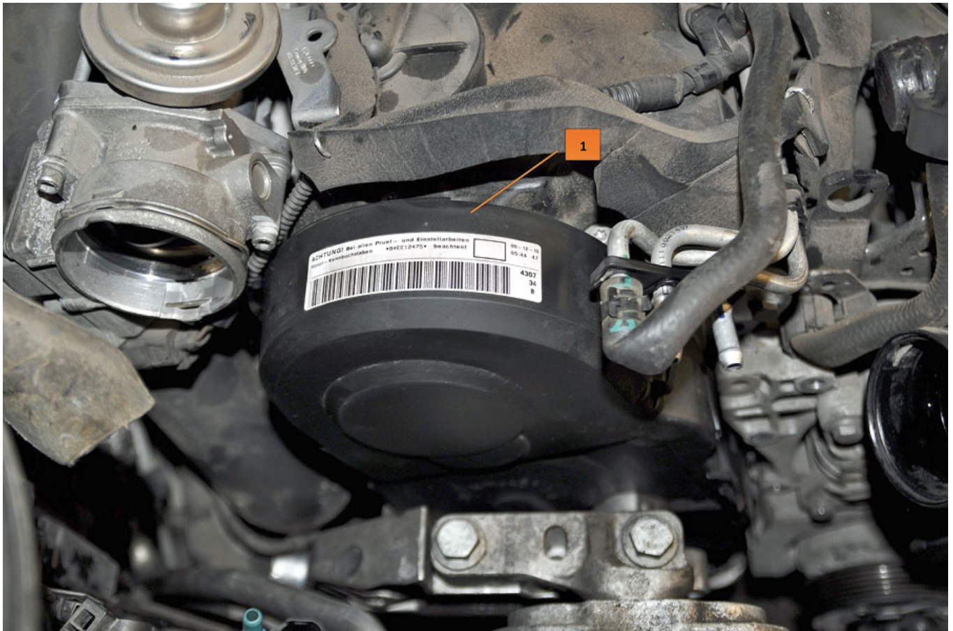
Фото 3. Блокування натягувача поліклинового ремня (1) фіксатором Т 10060 (2)
