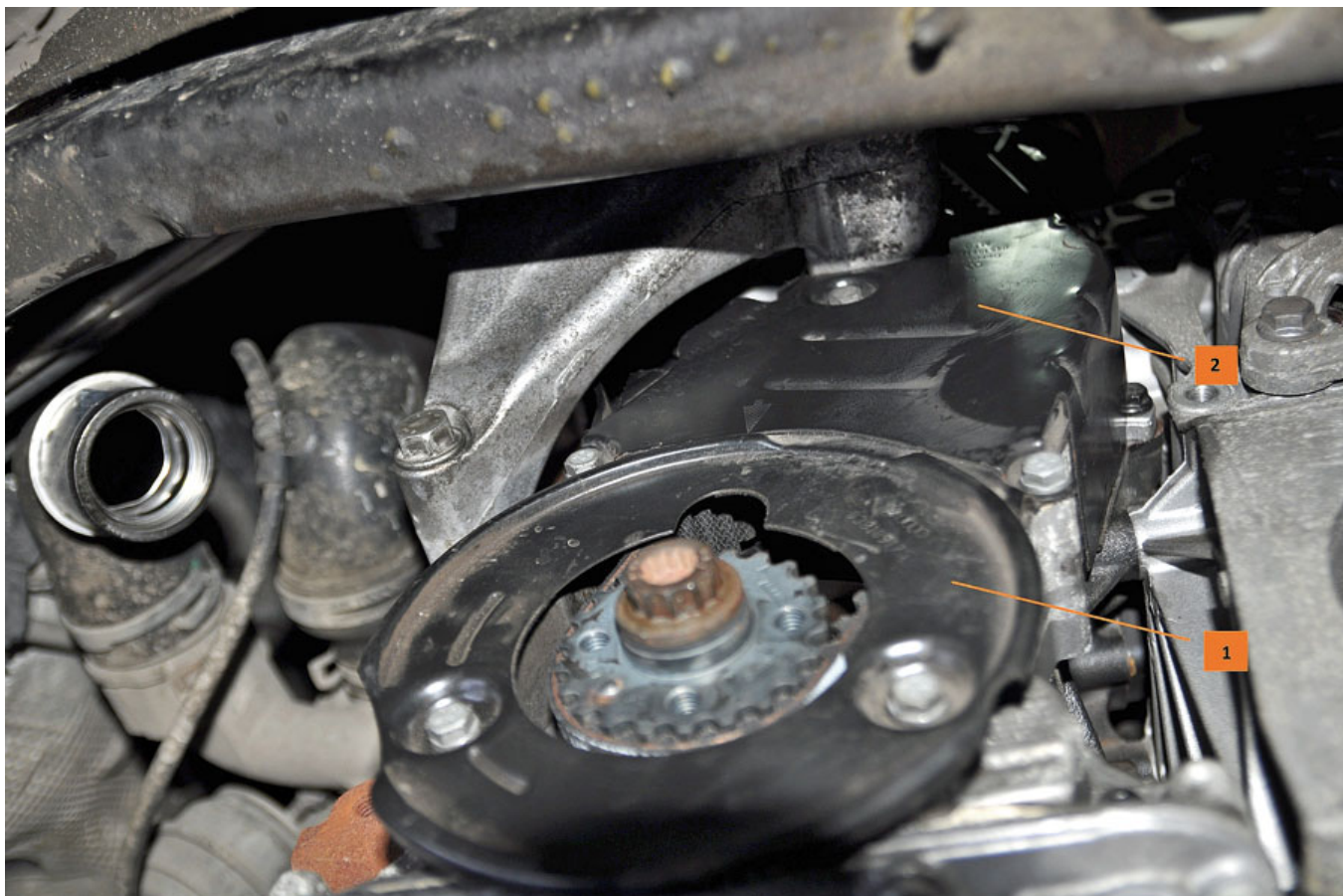
Фото 6. Розташування мітки на шестерні розподільного вала (1) на колінчастому валу при верхній мертвій точці та спосіб блокування розподільного вала за допомогою фіксатора 3359 (2). Болти кріплення шестерні розподільного вала (3)
