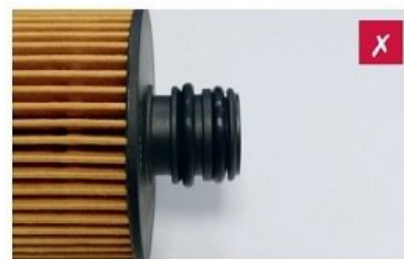
Фото 2. Неправильно встановлені сальники
