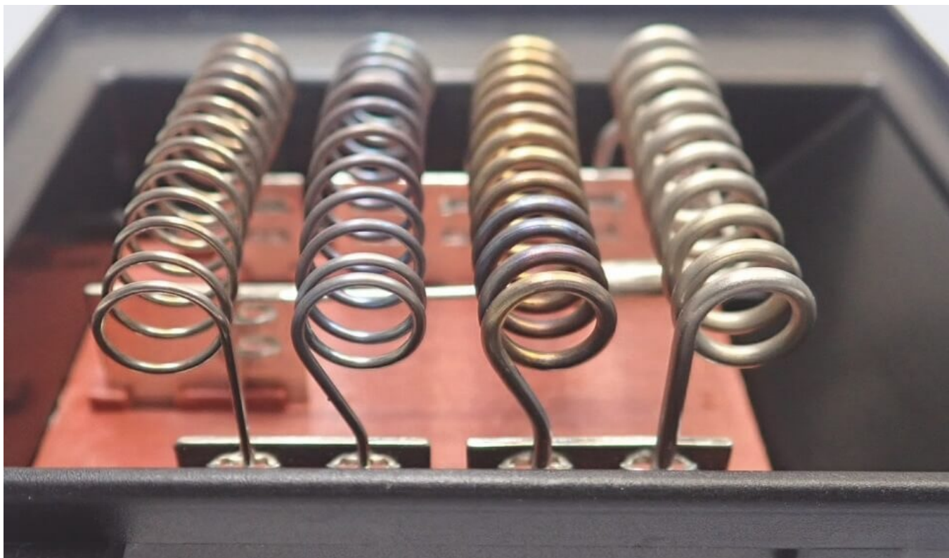
Фото. 2: Зміна кольору спірального резистора внаслідок впливу високої температури.
