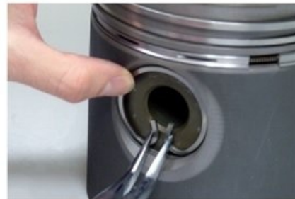
Фото. 3. Отвір в кільці в такому випадку повинен бути в положенні 6 або 12 годин
