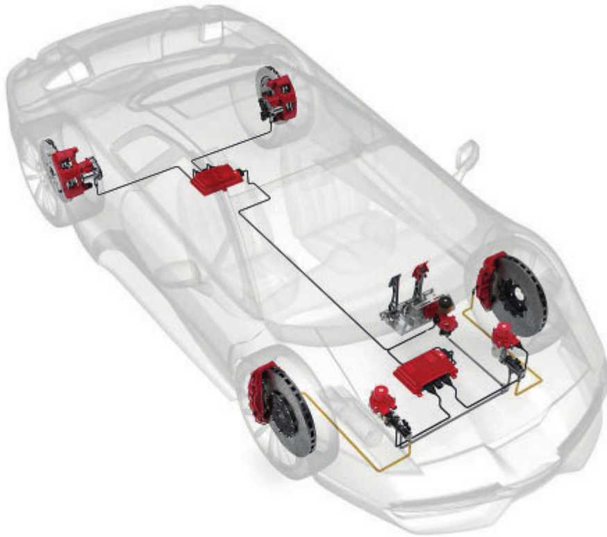
Фото. Система Brembo BBW (BrakeByWire)
