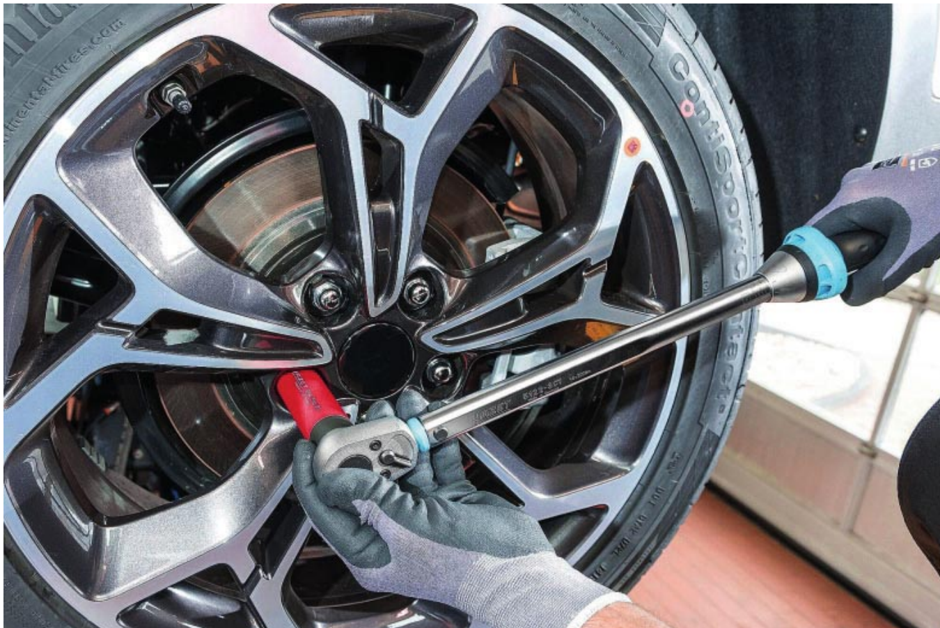
Фото.1. Помилкою є застосування однакового зусилля незалежно від типу транспортного засобу та різьбового з'єднання, що може призвести до надмірного затягування болтів і проблем з відкручуванням колеса під час поломки на дорозі.
