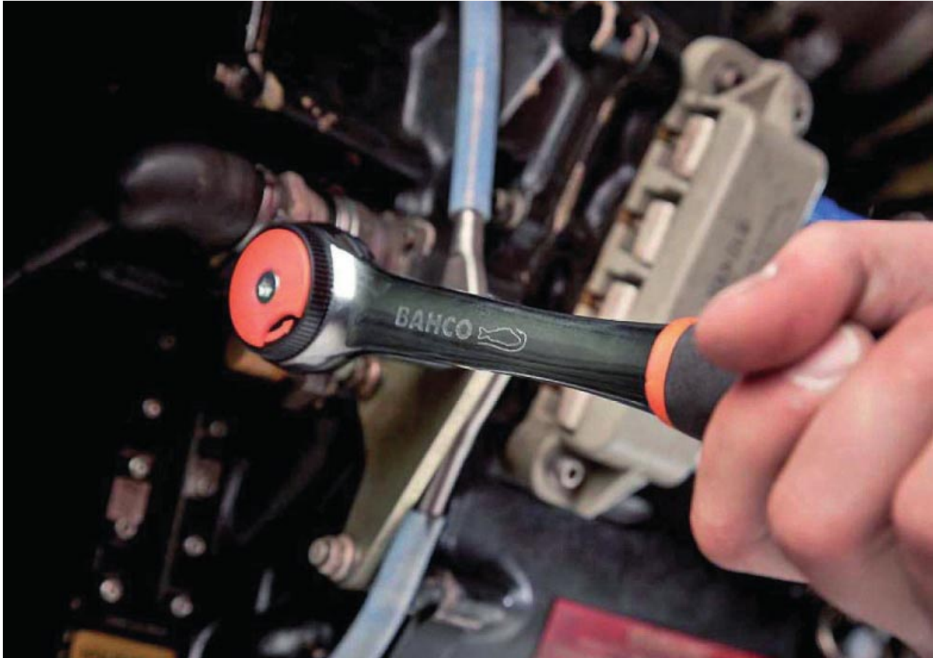
Фото. 4. Для відкручування пошкоджених гайок з заокругленими гранями створені гайкові ключі та головки Vahco з системою Dynamic Drive. Подібні властивості мають головки, профіль яких забезпечує міцне та надійне зчеплення з головою болта.
