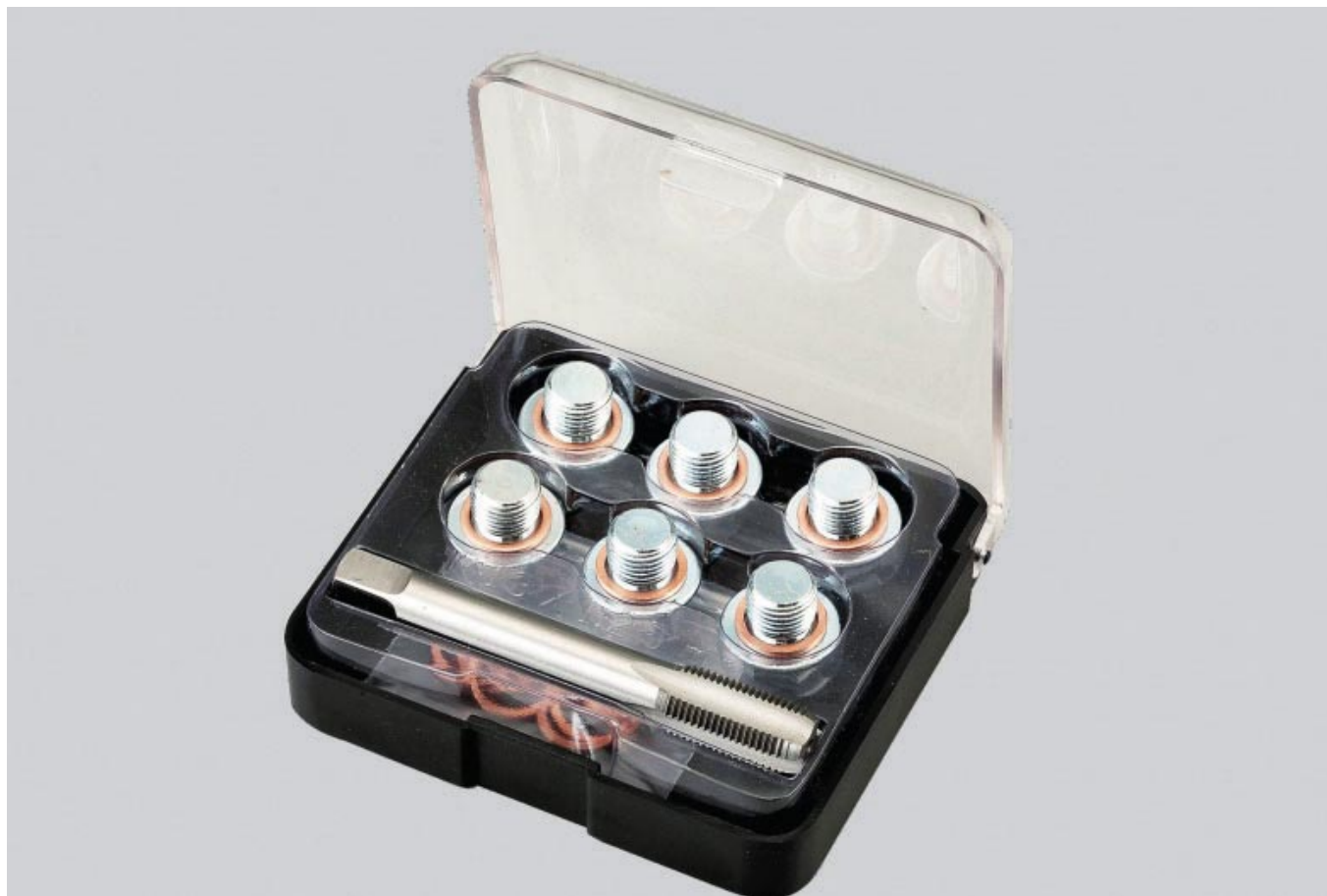
Фото.3. Такий міні-набір від Bahco забезпечує легку та швидку регенерацію пошкодженої різьби корка для зливу оливи шляхом нарізання нової різьби та встановлення корка.
