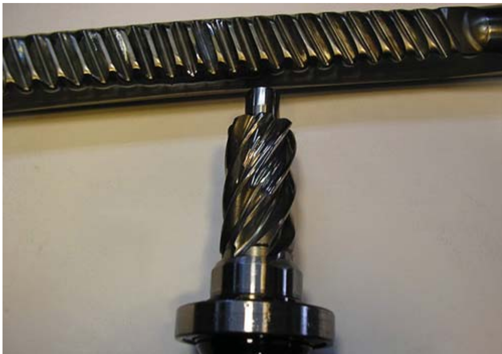
Износ червячного вала и штока рейки
