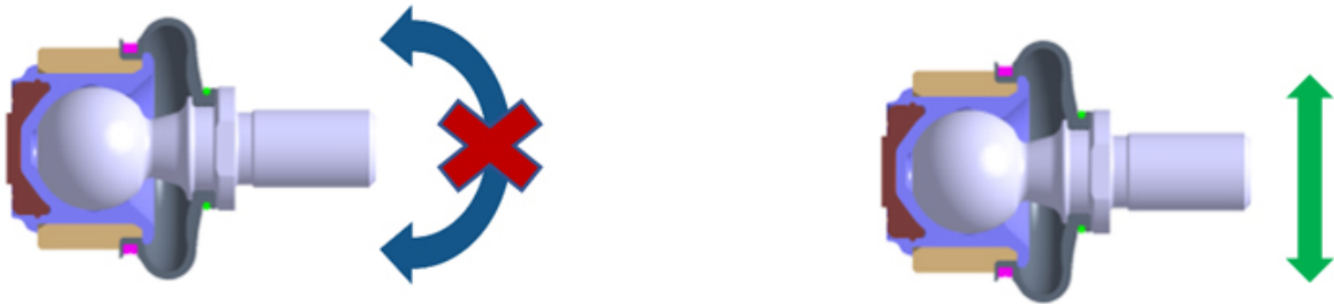
Рис. 2. Положення кульового пальця тяги стабілізатора.
