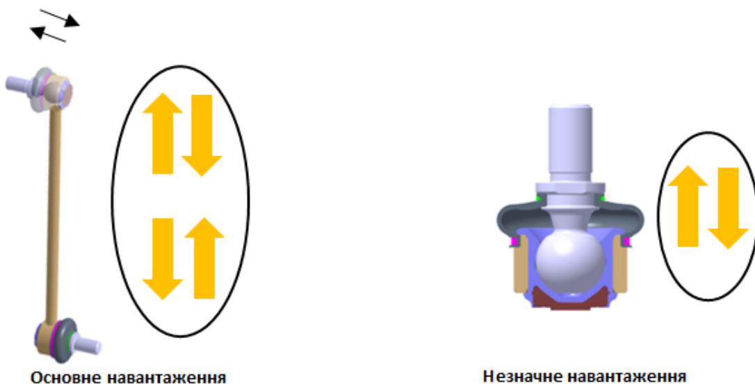
Рис. 1. Навантаження на тягу стабілізатора.
