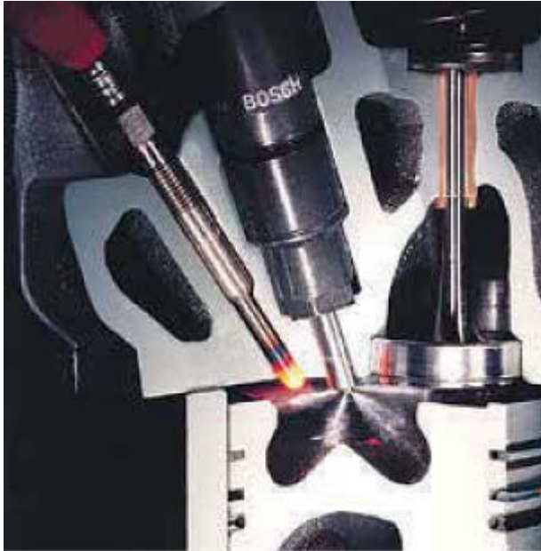
Рис. 2. Впорскування розпиленої дози палива в камеру згоряння за допомогою форсунки CR.
