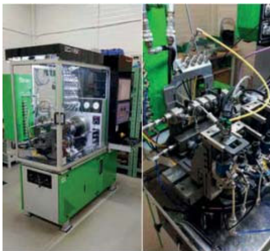
Рис. 5. Стенд для перевірки характеристик форсунок Common Rail та проекція форсунки, встановленої у затискач випробувального стенда.
