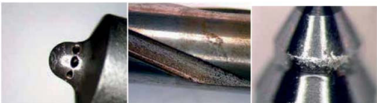
Рис. 3. Пошкодження функціональних елементів розпилювача: 1 – деформація розпилювальних отворів, 2 – корозійна втома голки, 3 – пошкодження діаметра сидла голки.
