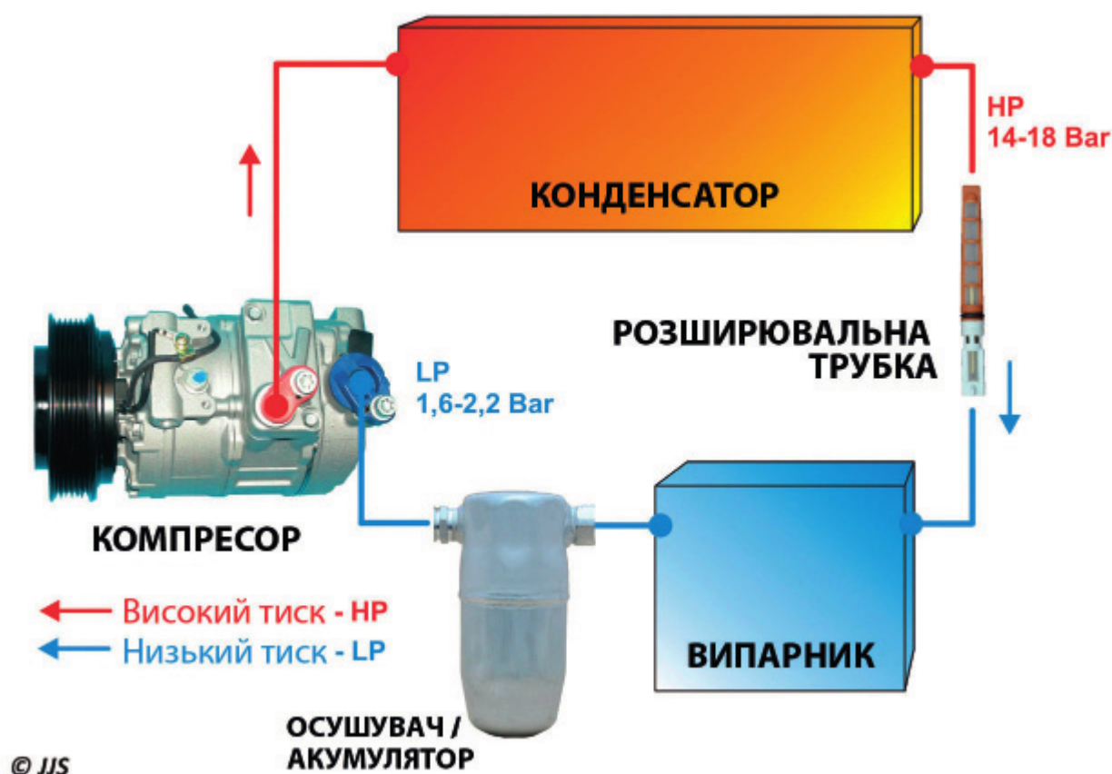
Система кондиціювання з розширювальною трубкою (рис.2)
