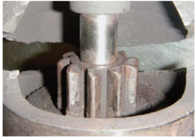
Рисунок 1: Излом деталей стартера: вал (слева) и фланец (справа)
