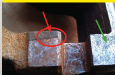
Фото 6. Поверхні скоби до та після очищення
