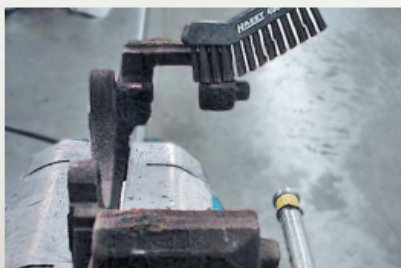
Фото 1. Зняти скобу та затиснути в тисках - єдина можливість як слід очистити її!
