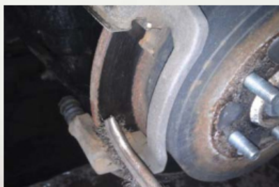
Фото 2. Так неможливо (!) як слід почистити скобу супорта, немає достатнього доступу до поверхонь!
