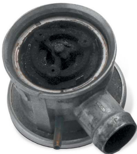
Повреждение под действием конденсата отработавших газов
