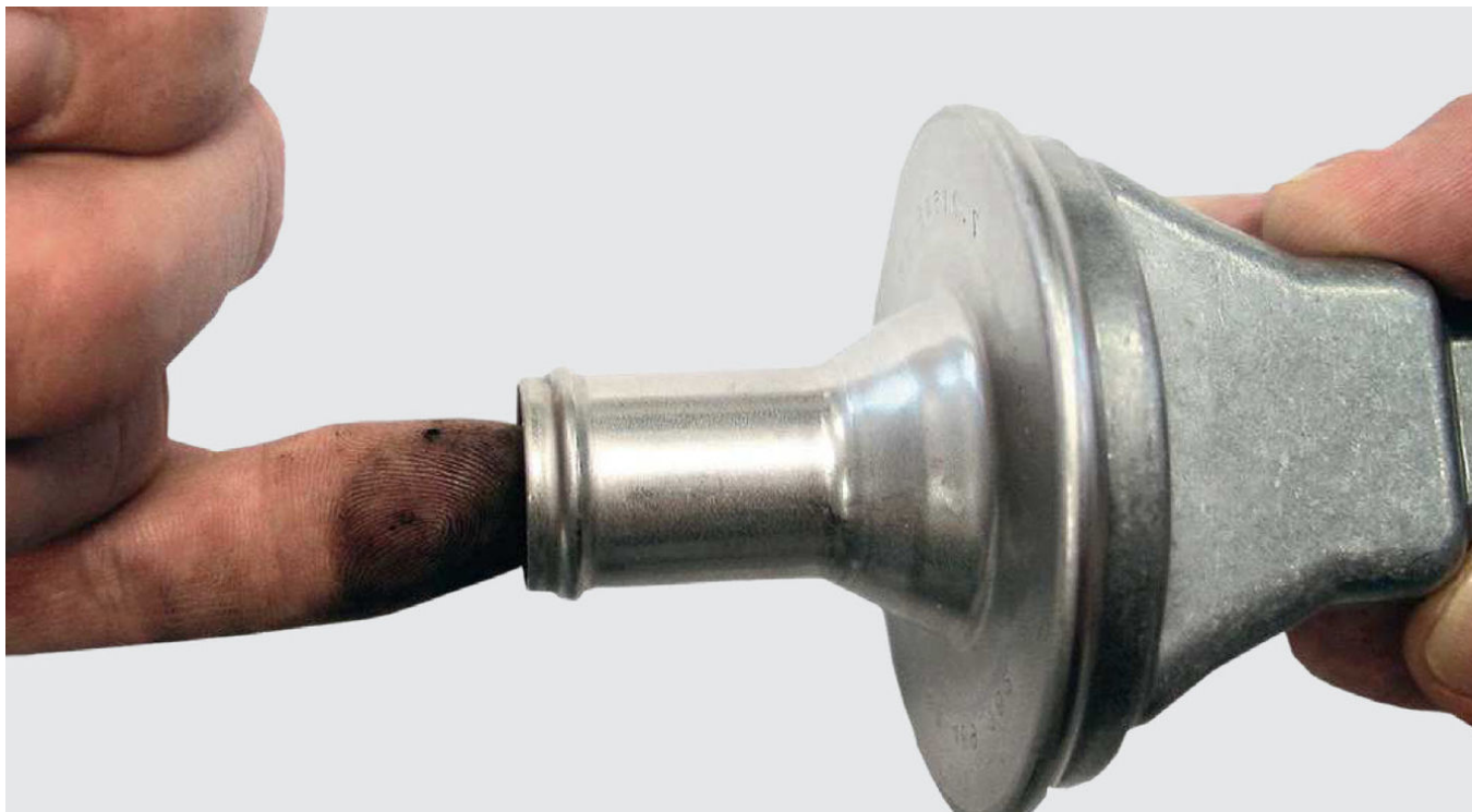
рис. 1 : Простое тестирование обратного клапана
