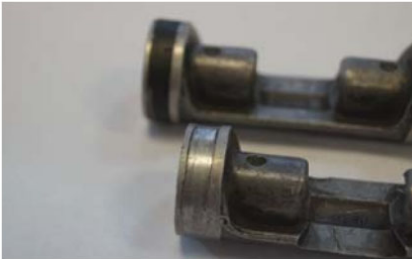
Приклади зносу поршнів компресора кондиціонера.
