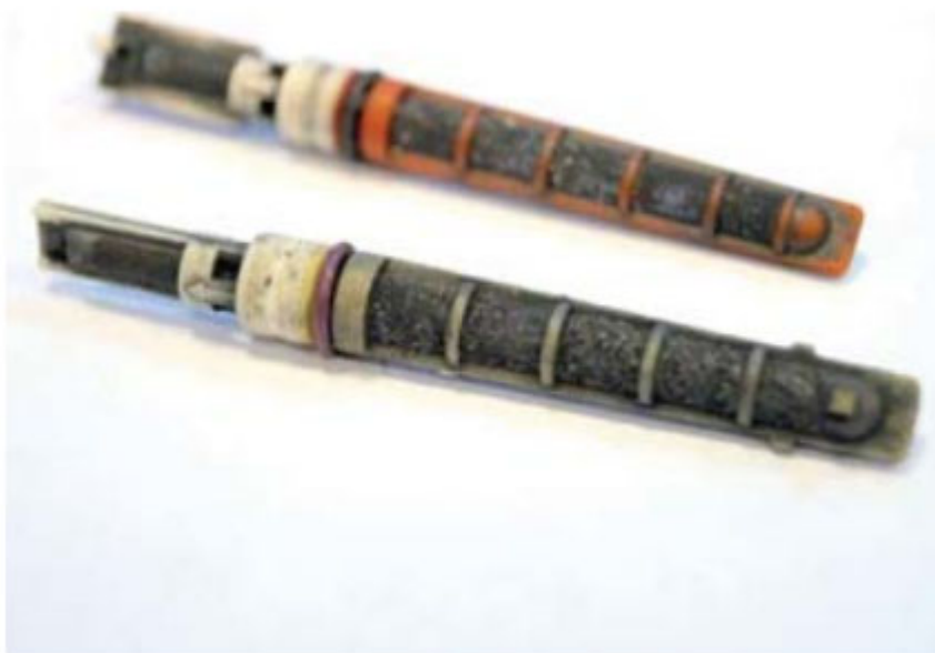
Приклади забрудненої трубки «Вентурі»
