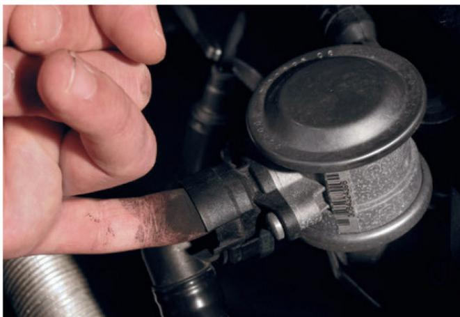
Простая проверка клапана вторичного воздуха
