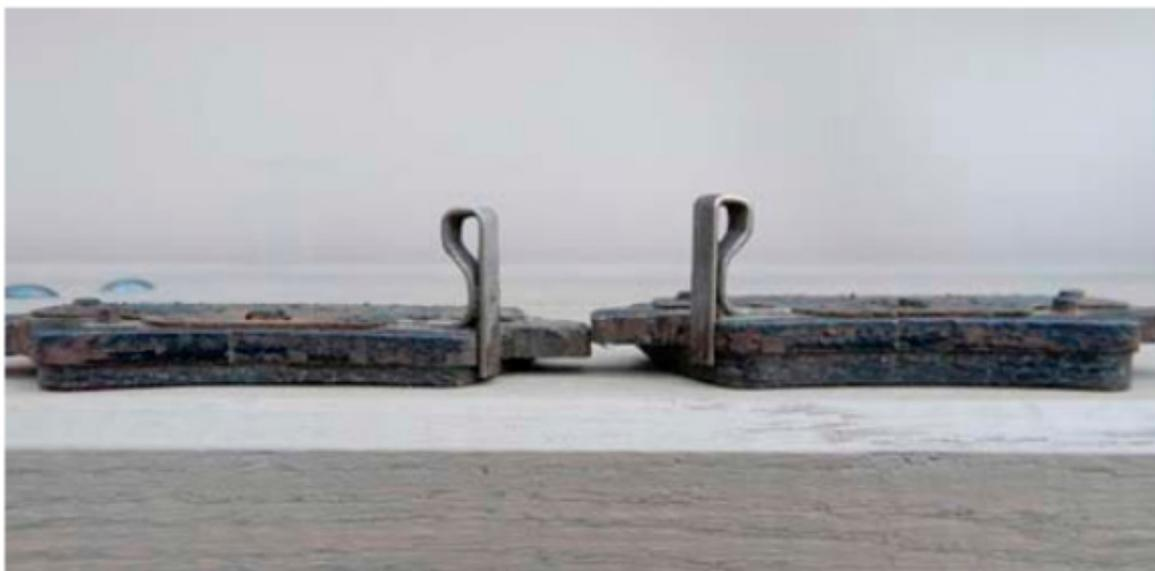
*Неравномерный износ колодок заднего суппорта в результате неисправности ручника*
