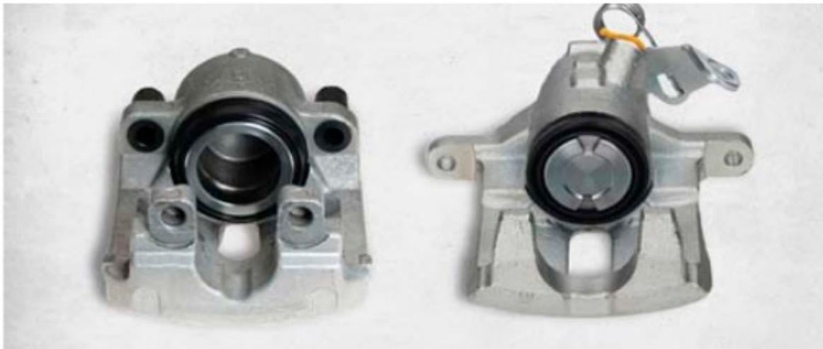
*Тормозной суппорт передней оси (слева) и задней оси (справа)*
