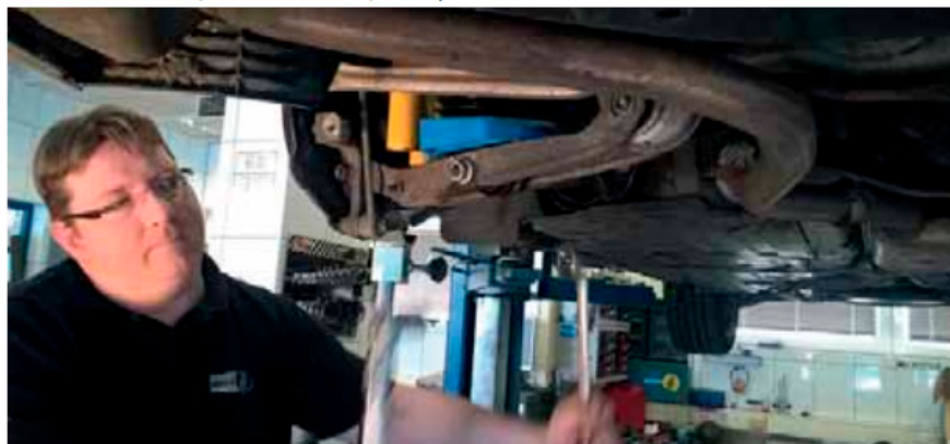
Фото 1. Відстань від важеля до основи корпусу пужини: а.-19 мм, б.-36 мм. Пневмопружина монтується під нахилом, кут якого забезпечує її паралельне положення.
