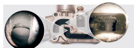
Фрагменты с увеличенным изображением: закоксованный клапан EGR (бензин)
