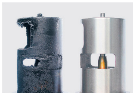
Заклинивший клапан EGR (дизель) и новый клапан
