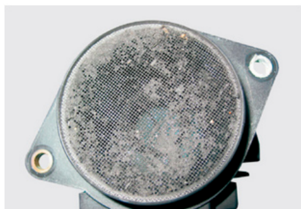
Ограничение потока через датчик расхода воздуха
