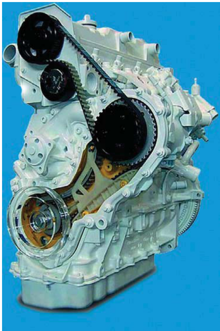
Ремень в масляной ванне двигателя Ford Lynx 1.8
