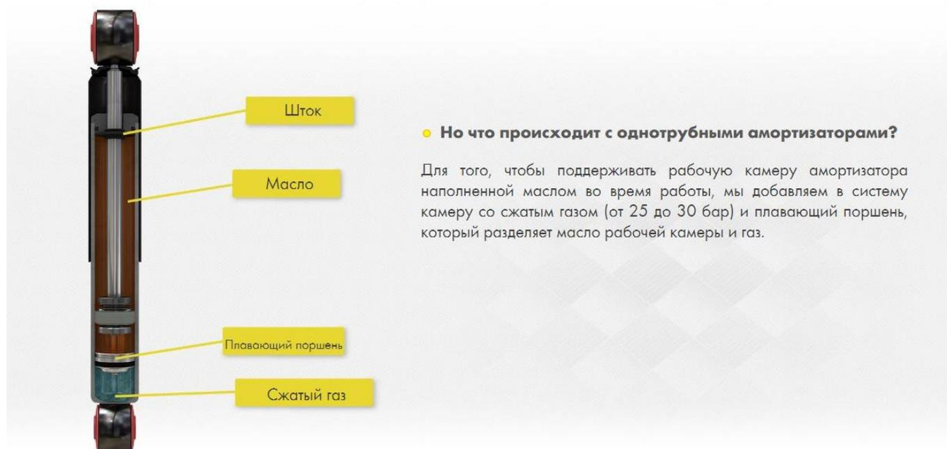
Рисунок 2. Однотрубный газонаполненный амортизатор
