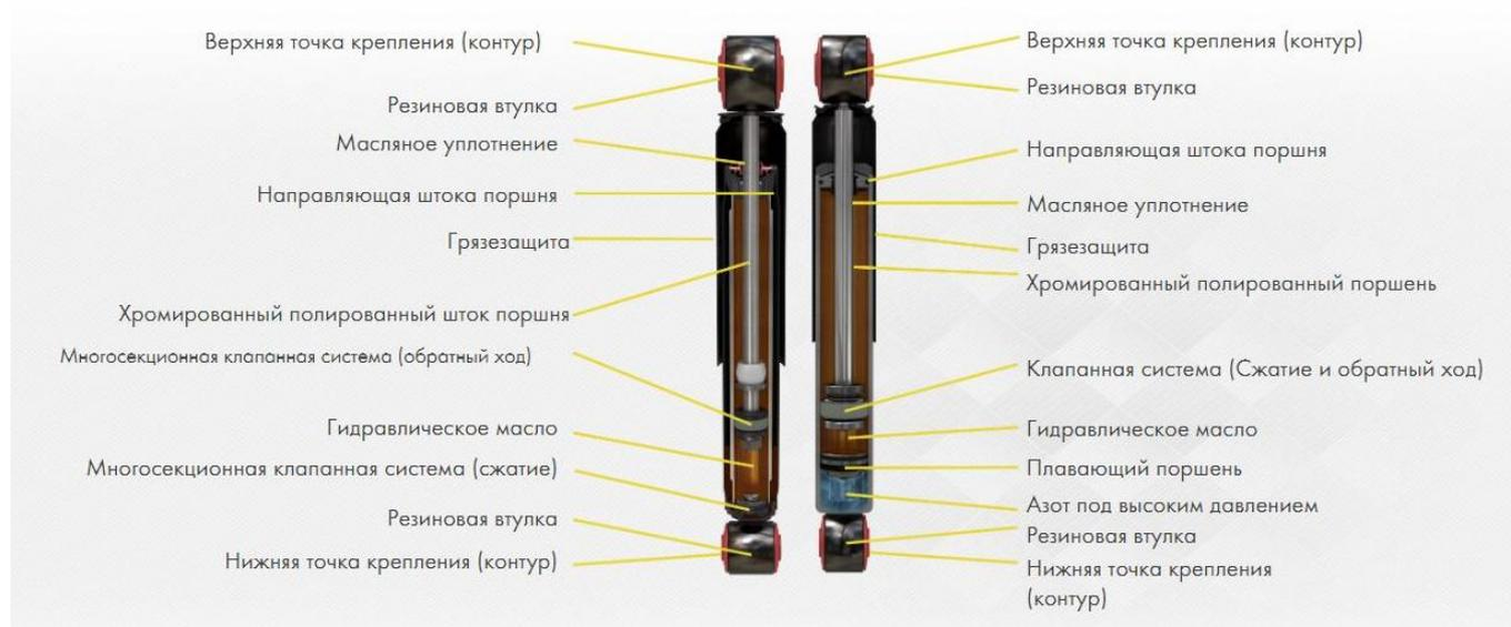
Рисунок 3. Два типа конструкции амортизаторов. Гидравлический двухтрубный амортизатор (слева) и газогидравлический однотрубный амортизатор (справа)
