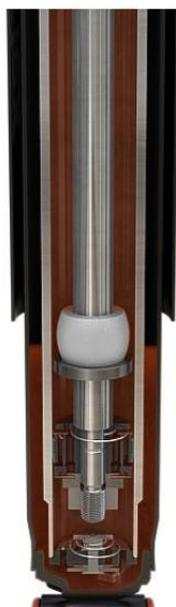
Здесь показан амортизатор в установившемся режиме, когда работающая труба и вторая труба в равновесии.
