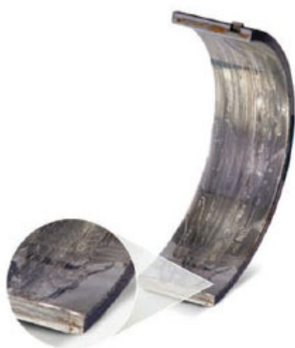
Нижний вкладыш коренного подшипника, композит сталь-алюминий
