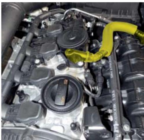
*Рисунок 3: Вентиляционный контур перед турбонагнетателем*
