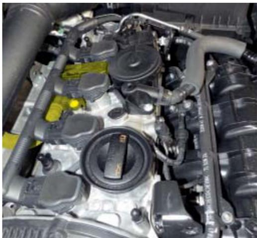
*Рисунок 2: Вентиляционный контур за турбонагнетателем с прямым входом во впускную трубу*
