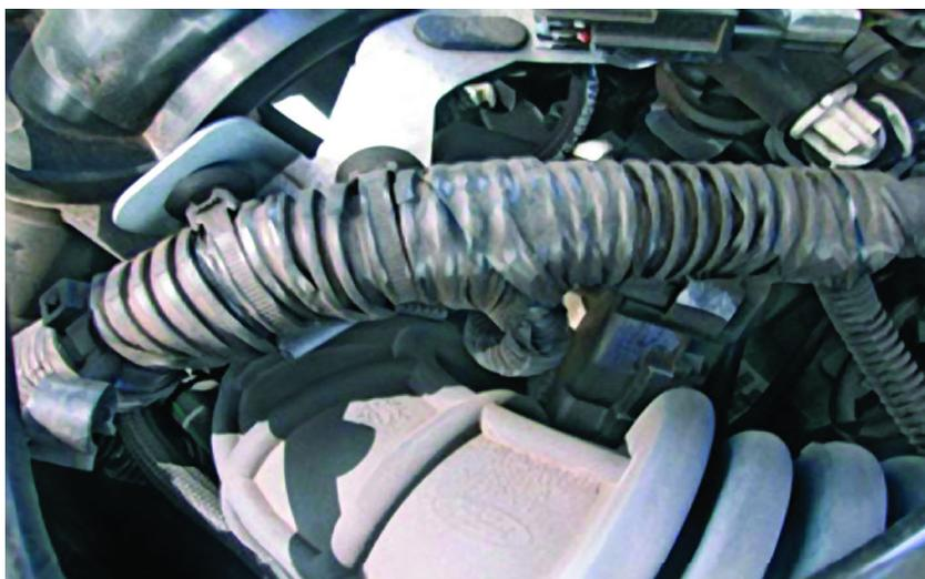
На практике наиболее простые для устранения неисправности вызваны отсутствием проводимости или значительно увеличенным сопротивлением электрических соединений, контактов и разных типов переплетов. Данного типа повреждения обычно вызваны влагой. В таких случаях необходимо проверить соединения с массой и проследить электрическое соединение между потребителем и источником тока. Отсутствие электрического соединения с «массой» обозначает то, что необходимо
