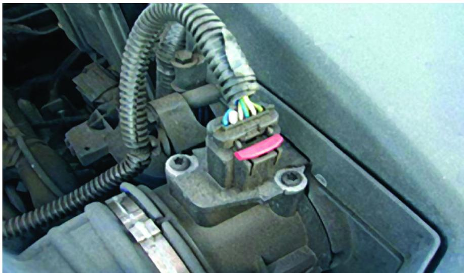
Следующей цепью электрооборудования автомобиля является цепь потребителей тока. Все потребители в электрооборудовании автомобиля соединены параллельно. Их отрицательные полюса соединены с «массой», а положительные с индивидуальным проводом питания. Провода, питающие отдельные потребители, сплетены по конструкционным и технологическим соображениям в соответствующие разветвленные пучки и обозначены разноцветными изоляциями для более легкой идентификации типов соединений.
