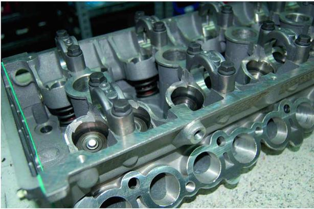
гидрокомпенсаторами, из-за их ненаполнения маслом. Такой стук по частоте совпадает со стуком распредвала, по тональности - звонкий. В дизелях может стучать ТНВД (топливный насос высокого давления). Может стучать поршень, доставая клапана при сбитых фазах газораспределения.
