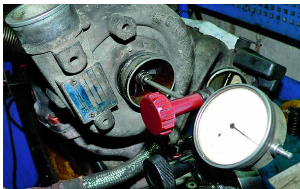
В результате осмотра и проведенных измерений подозрения на износ деталей отпали. Далее следует проверить вероятность выброса моторного масла через динамические уплотнения вала турбины. При снятых патрубках нагнетающей улитки и режиме х.х. двигателя, промываем её керосином, подавая одноразовым шприцем его во всасывающую горловину улитки компрессора. При этом собираем промывочную жидкость на выходе в заранее подготовленную ветошь.
