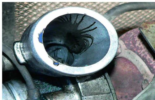
Производительность турбокомпрессора несложно проверить применением манометра, включенного в выходной патрубков или в разрыв датчика измерения давления во
