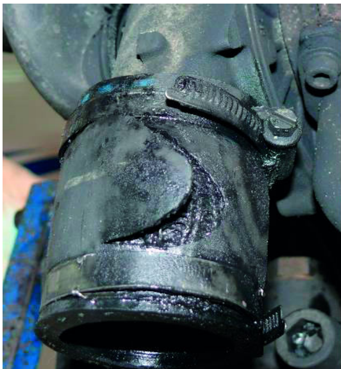
Потеря герметичности радиатора охлаждения воздуха после турбины (интекуллер) .
