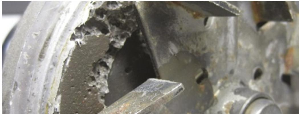
*Кавитация: естественная кавитация («пузырьки воздуха»), образующиеся в охлаждающей жидкости, схлопываются с взрывной силой, оставляя отметины на отдельных деталях помпы.*
