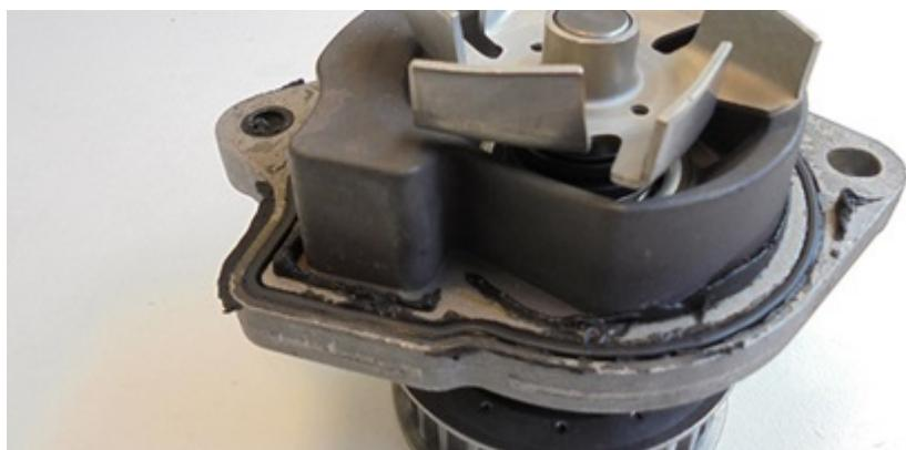
*Используйте герметик только по рекомендации автопроизводителя и наносите его согласно инструкциям.*
