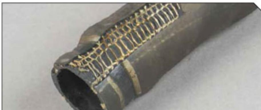
**Признаки:** Тепловое повреждение может возникать как внутри, так и снаружи. Незначительное вздутие является одним из признаков внутреннего повреждения. Если в результате высокой температуры произошло сильное повреждение внутренних нитей оплетки, шланг станет мягким и на нем даже могут появиться вздутия. Проще обнаруживаются внешние тепловые повреждения, поскольку внешнее покрытие поврежденных высокой температурой патрубков становится огрубевшим, глянцевым и покрытым трещинами.
