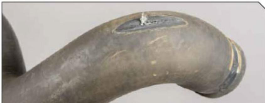
**Признаки:** Механическое повреждение может быть обнаружено по наличию потертостей или повреждений внешнего покрытия патрубка.
