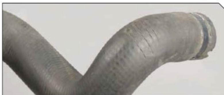
**Признаки:** Тонкие, параллельно расположенные трещины на внешнем покрытии, обычно на изгибах патрубка.
