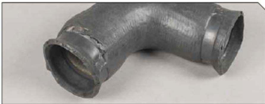
**Признаки:** Патрубок становится мягким или губчатым на ощупь. Появляются явные вздутия и разбухания. **Причина:** Масло химическим образом воздействует на резиновую основу патрубка и ослабляет молекулярные связи. Это вызывает размягчение патрубка, набухание и расслоение, приводящие к его выходу из строя. **Решение:** Замените патрубок и устраните источник попадания масла. Если это невозможно, измените маршрут прокладки патрубка.
