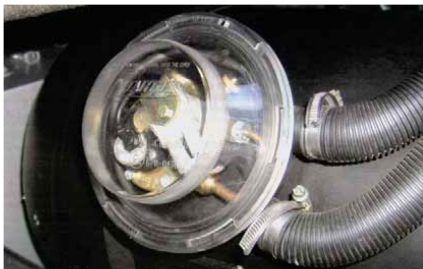
Рис. 5. Образец баллона, оснащенного газонепроницаемым корпусом, который закрывает только клапана.
