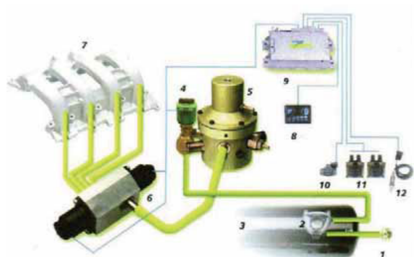
Рис. 2. Схема газовой установки Etagas с избыточным давлением LPG (система 3 поколения).
