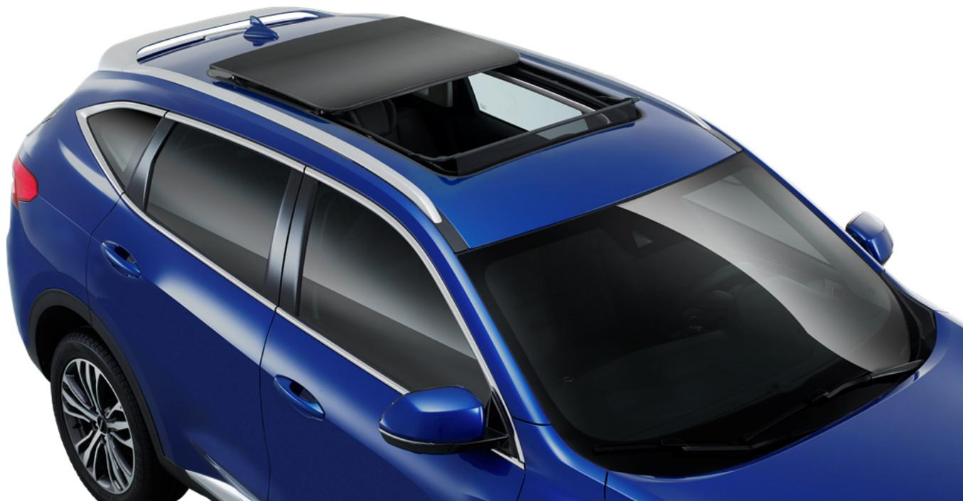
*Двухпанельная панорамной крыша с электроприводом, установленная на модель Haval F7*
