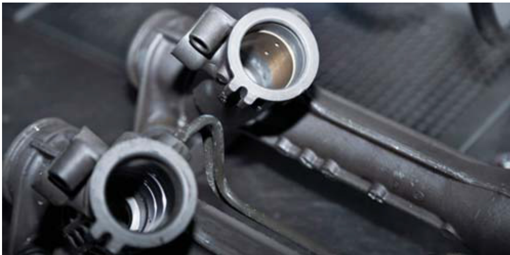
Корпусы распределителя с кольцевым износом (снизу) и с бронзовой гильзой (сверху)
