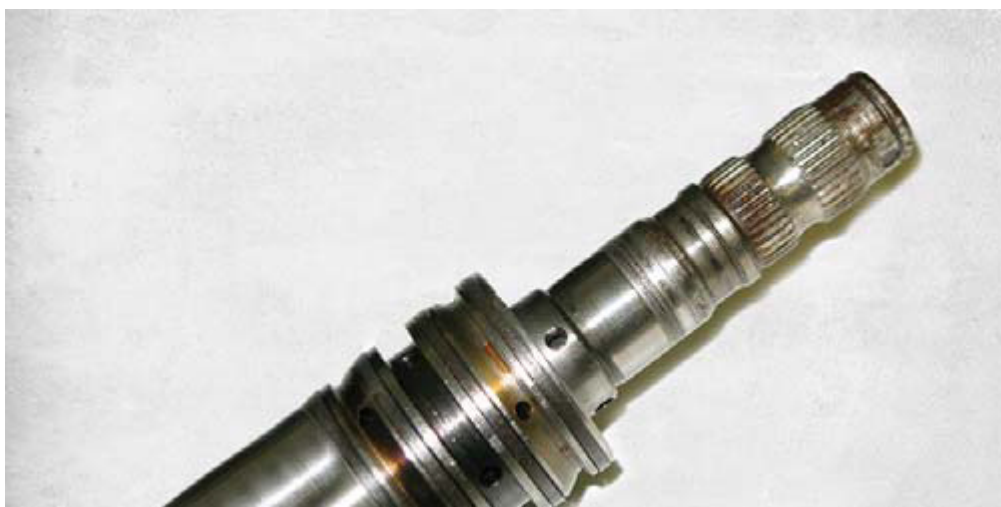
Ржавчина на распределителе – причина множества неисправностей рулевой рейки
