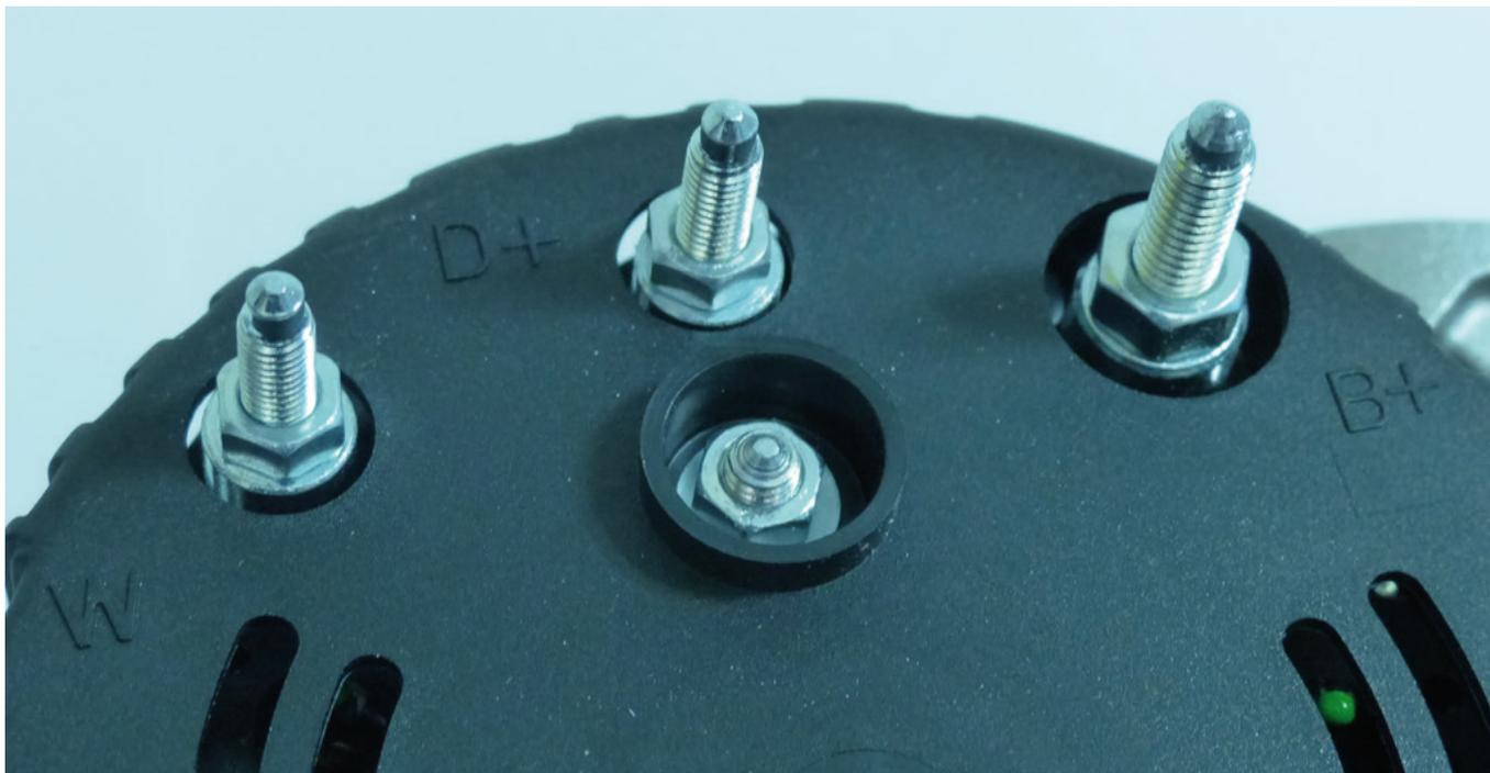
*Рисунок 2: Маркировка клемм на генераторе: W = сигнал числа оборотов, D+ = сигнализатор зарядки и B+ = плюсовой выход аккумулятора*
